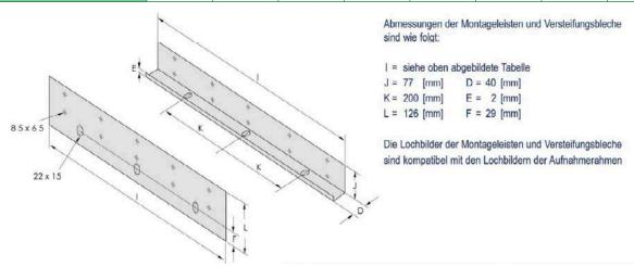
**Hinweis:** Wandstärke der Aufnahmerahmen, der Montageleiste und des Versteifungsbleches beträgt 1,25 mm in der Standardausführung mit verzinktem Stahlblech
